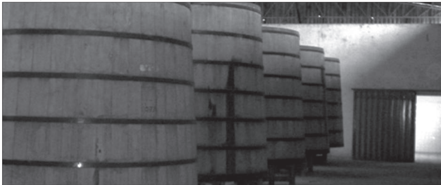
Envelhecida em dornas de madeiras, a cachaça ganha aroma e paladar característicos antes de ser envasada
